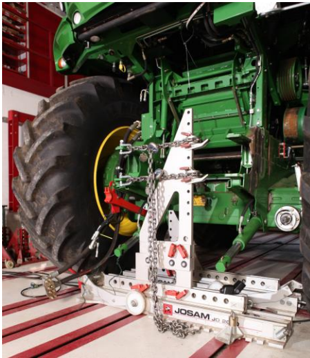
Professionelle Richtarbeiten an einem Häcksler
